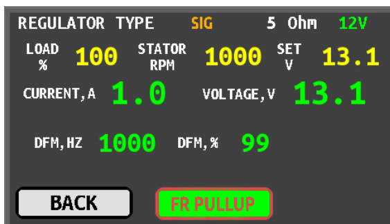
Рисунок 11. Экран диагностики регуляторов SIG, P-D
