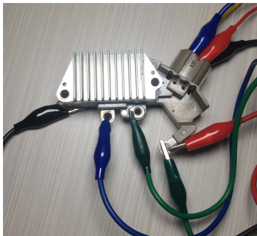
Figura 18. Regulador ARE6076 conectado a las salidas del probador
