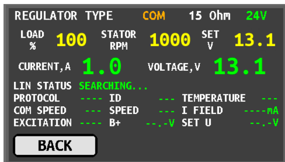
Rysunek 13. Ekran diagnostyczny regulatora COM 24V
