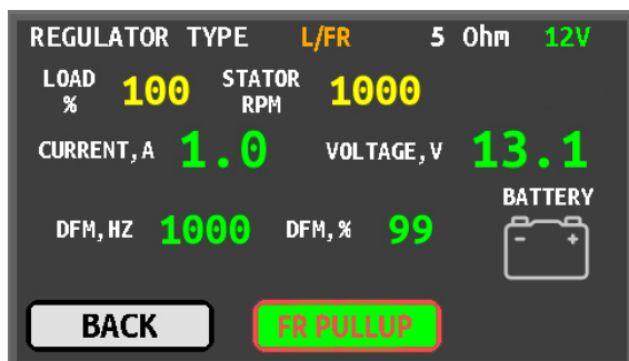
Rysunek 10. Ekran diagnostyczny regulatora L/FR (12/24V)
