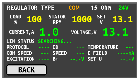
Figura 13. Pantalla de diagnóstico del regulador COM 24V
