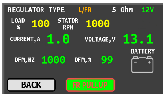
Figura 10. Pantalla de diagnóstico del regulador L/FR (12/24V)
