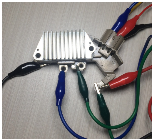
Рисунок 18. Регулятор ARE6076, подключённый к разъёмам тестера
