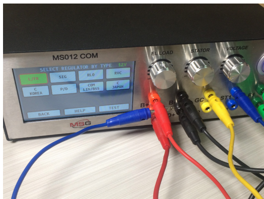
Рисунок 19. Підключення додаткового провodu В+
