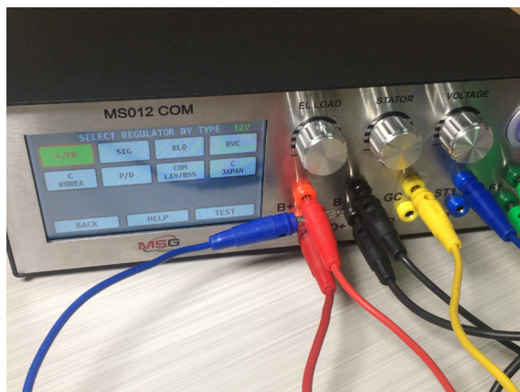
Rysunek 19. Podłączenie dodatkowego przewodu B+
