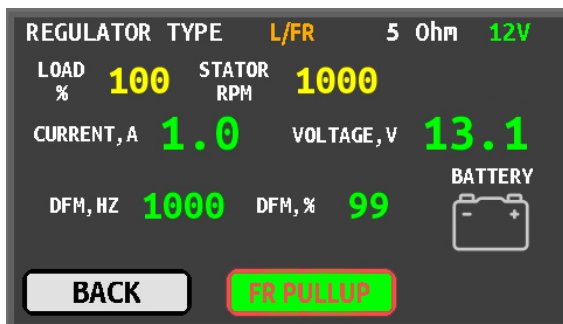
Рисунок 10. Экран диагностики регулятора L/FR (12/24V)
