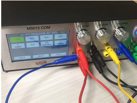
Figura 19. Conexión de un cable B+ adicional
