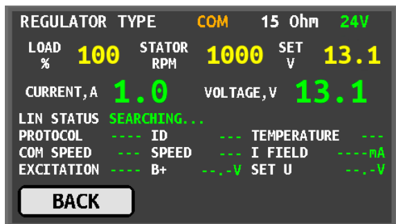
Рисунок 13. Экран диагностики регулятора COM 24V
