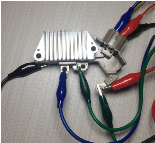
Рисунок 18. Регулятор ARE6076, під'єднаний до роз'ємів тестера
